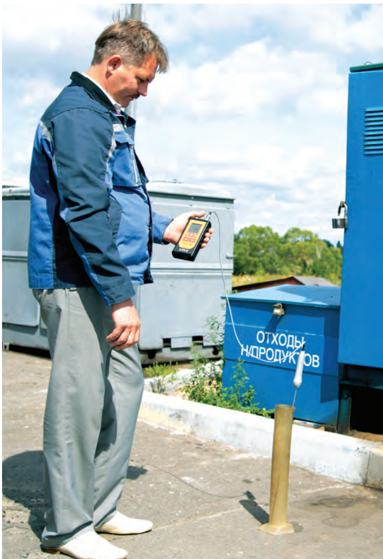
Термометр состоит из электронного блока и сменных зондов
